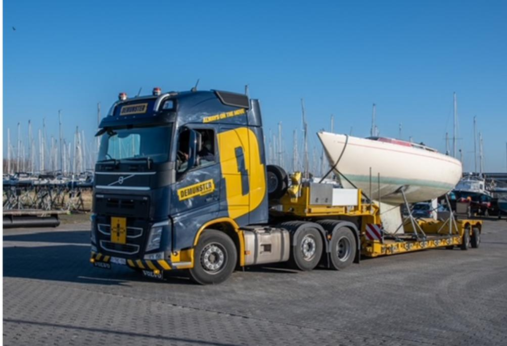
Notre chargeur Euro est la crème de la crème en matière de transport à plat mi-lourd. La remorque est équipée de 2 essieux pendulaires de 12 tonnes et est radiocommandée depuis la cabine. Avec la hauteur du plancher chargé, nous pouvons charger des machines jusqu'à 4,50 m. Le lit inférieur est extensible jusqu'à 17,20 m ; unique en son genre ! Les autobus, les excavateurs, les structures hors gabarit, etc. ne posent aucun problème à cette combinaison.
